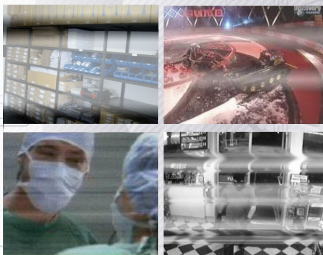
Figura 1. Exemplos de imagens com problemas de loop de terra.
